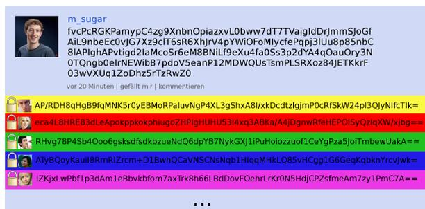
Abbildung 4.5: Für jeden Freund wird der verschlüsselte Schlüssel an den Text gehen
